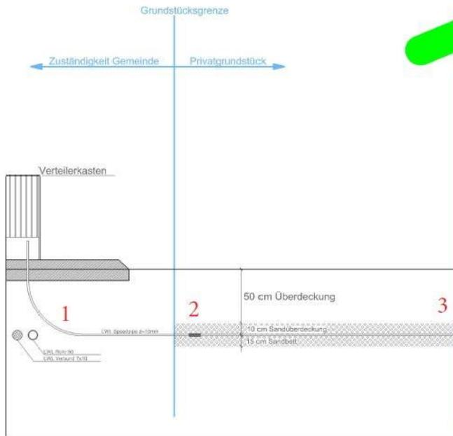
**Achtung:** Der LWL - Anschluss erfolgt nur bis zum Providermodem (Standort: Übergabe Hausanschlussbox), die weitere Verlegung im Gebäude muss vom Eigentümer erfolgen, bzw. kann auch eine bestehende LAN (CAT 5 oder CAT 7) Verkabelung verwendet werden.
